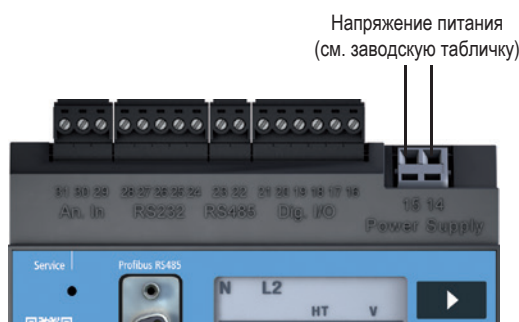
Рис. 23.1. Пример подключения для напряжения питания U_h
