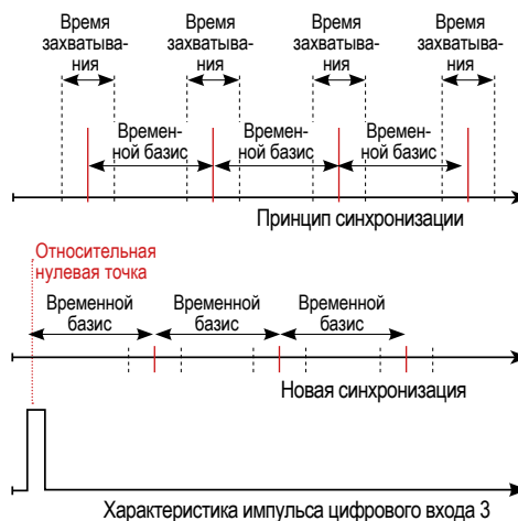
Рис. Принцип синхронизации с «импульсом вне времени захватывания»
